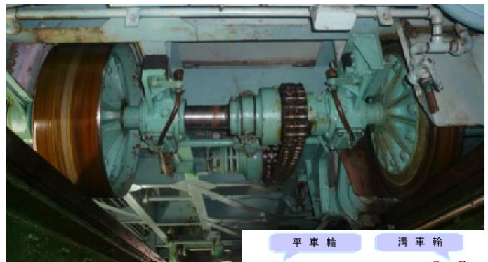
写真2 車輪 左 平車輪 右 溝車輪(両フランジ)
